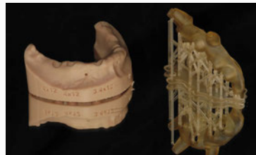
4. Das Meistermodell im Labor und Herstellung der Bohrschablone.
