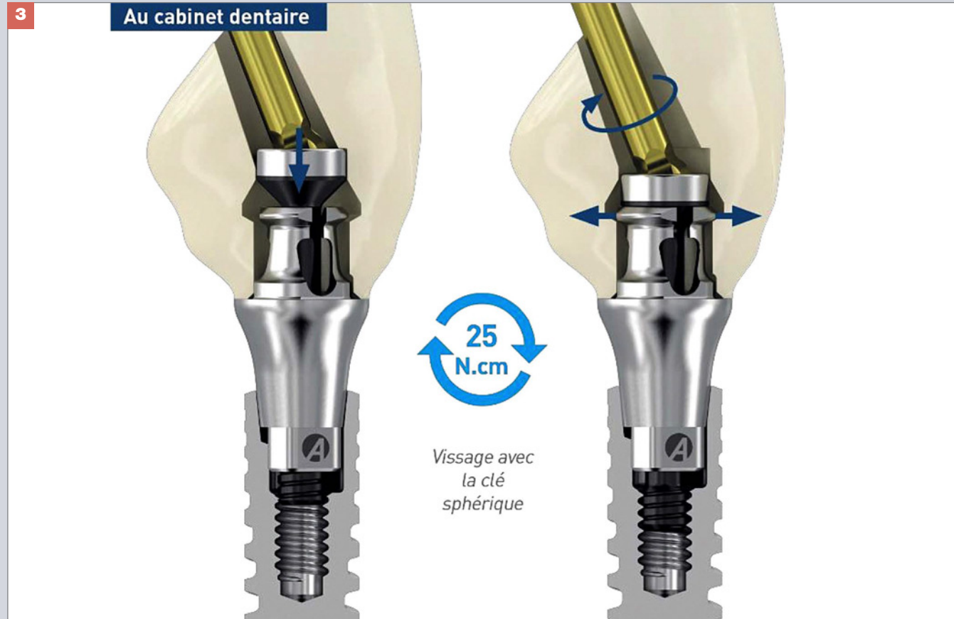
Mécanisme de verrouillage par le puits de 2 mm de diamètre
