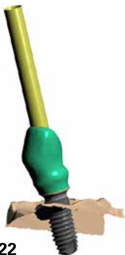
21 et 22. Design du pilier personnalisé sur Simedica® CAD.
