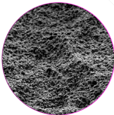
Repräsentative Aufnahme der Implantatoberfläche – Rasterelektronenmikroskop (REM) mit 5000-facher Vergrößerung
