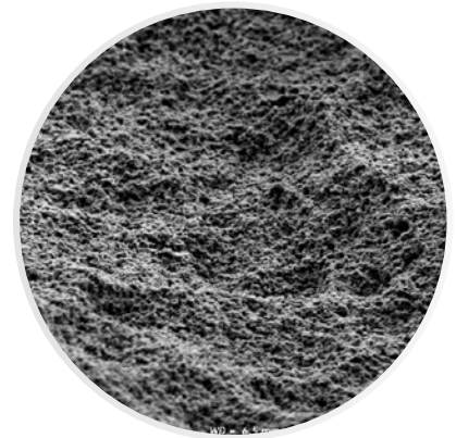
Repräsentative Aufnahme der Implantatoberfläche – Rasterelektronenmikroskop (REM) mit 5000-facher Vergrößerung
