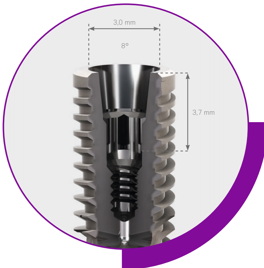
ABBILDUNG 3. Das Grand Morse® Implantat von Neodent® weist auf seiner Innenseite eine tiefe Verbindung auf, die die Kontaktfläche zwischen dem Implantat und dem prothetischen Sekundärteil vergrössert.
