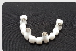
8) Abschrauben der Infrastruktur vom Modell. Fertiggestelltes Gerüst mit passivem Sitz.
