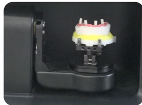
2) Einsetzen des Scankörpers für das GM Mini Konische Sekundärteil in das Modell und Scanvorgang.
