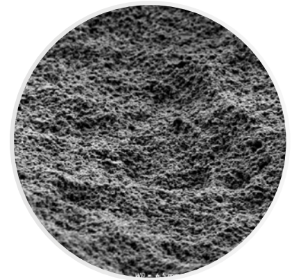
Image représentative de la surface implantaire - Microscope électronique à balayage (SEM) avec un grossissement de 5000x.
