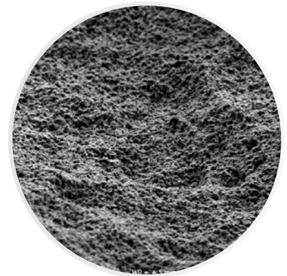
Immagine rappresentativa della superficie implantare. Ingrandimento al microscopio elettronico a scansione (SEM) di 5000x.
