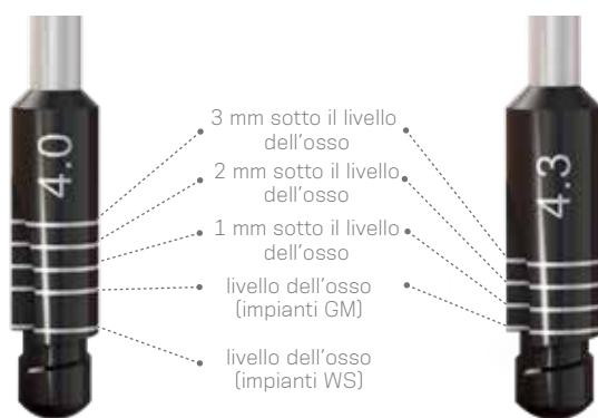
FIGURA 22: Fresa pilota per la preparazione avanzata del letto implantare per l'impianto. La fresa facilita il posizionamento cervicale dell'impianto in zone con maggiore densità ossea: a livello dell'osso, 1, 2 o 3 mm sotto il livello osseo. Le fresa pilota sono facoltative per gli impianti Drive GM®.
