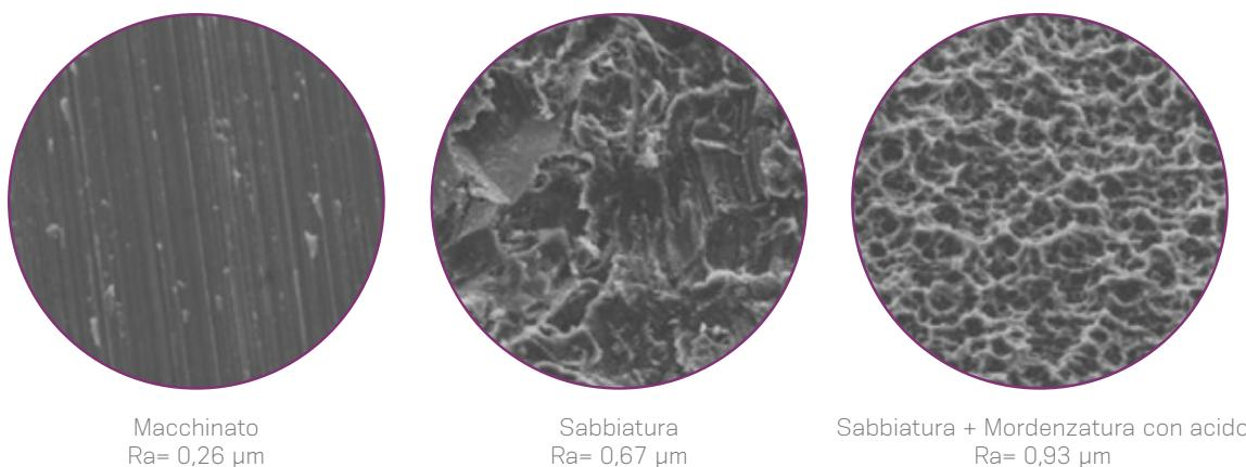
FIGURA 8. Processo di produzione fisica del trattamento di superficie Neodent®.
