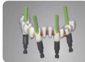
3) Execute o design da barra de zircônia no software CAD/CAM.
