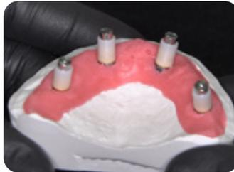
2) Cilindros de latão são instalados sobre os análogos e recebem cilindros calcináveis fixados com parafusos de trabalho.
