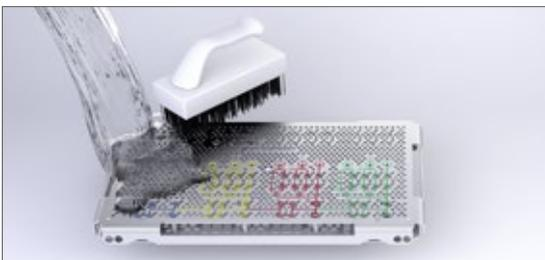
Zerlegen Sie die Kassette (Deckel, oberer Einsatz und unterer Einsatz) und reinigen Sie alle Teile mit einer weichen Nylonbürste unter vollentsalztem Wasser vor, bis keine sichtbaren Verunreinigungen (Vergrößerungsglas mit 3-facher Vergrößerung) mehr zu erkennen sind.
