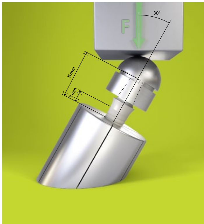
Abb. 1: Testaufbau nach ISO 14801
