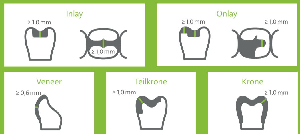
Richtlinien zur Mindestwandstärke der n!ce® Glass-Ceramic Restauration
