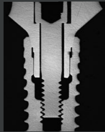
Componente secondaria Atlantis™ CAD/CAM Ti su impianto Straumann® RC 4.1
