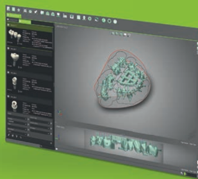
Calcolo automatico del percorso di fresaggio: processo di calcolo con blocco di supporto sinterizzazione
