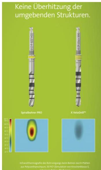
Kumulative gemessene Energie oberhalb Raumtemperatur (25 °C) beim Bohren durch eine Platte aus Polyurethanschaum, 50 PCF (Simulation von Knochenklasse I)
