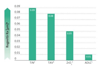
La ruvidità di una zona di superficie è indicata dal parametro di rugosità Ra – minore è il valore del parametro, più liscia è la superficie.
